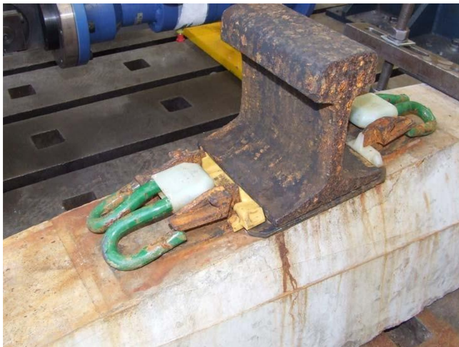
B.6 paveikslas: Sąranka išardyta po korozijos bandymo
