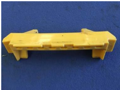
B.3 paveikslas: Izoliatoriai po pakartotinės apkrovos bandymo
