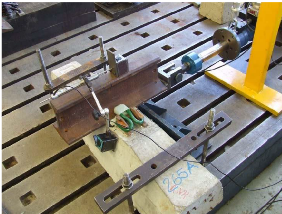
3.3.1 paveikslas: Bėgių atsparumo išilginiam poslinkiui bandymo komplektas
