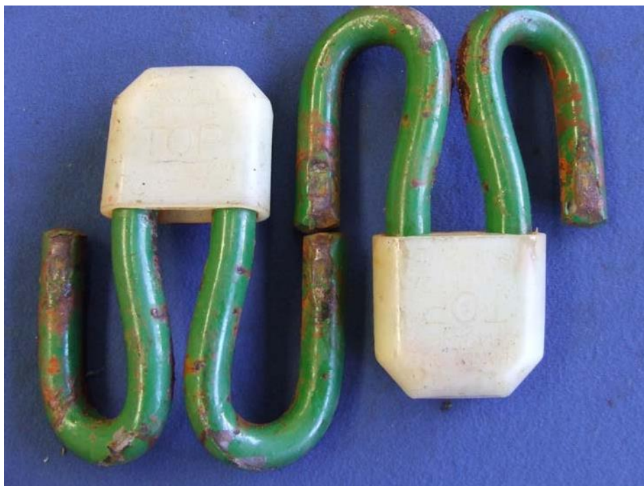
B.8 paveikslas: Bėgio gnybtų viršutinis paviršius po korozijos bandymo
