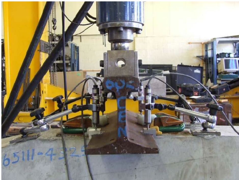
3.4.1 paveikslas: Vertikalaus standumo bandymo komplektas
