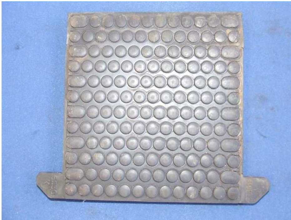
B.1 paveikslas: Bėgio padėklo viršutinis paviršius po pakartotinės apkrovos bandymo
