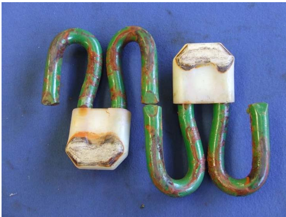
B.9 paveikslas: Bėgio gnybtų apatinis paviršius po korozijos bandymo
