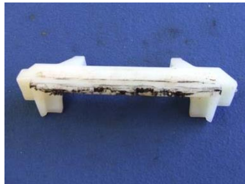
B.3 paveikslas: Izoliatoriai po pakartotinės apkrovos bandymo
