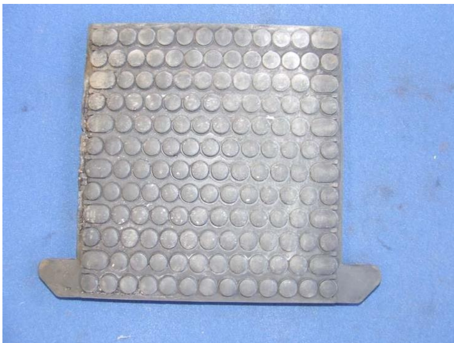
B.2 paveikslas: Bėgio padėklo apatinis paviršius po pakartotinės apkrovos bandymo
