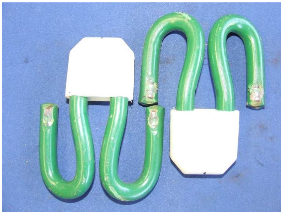
B.4 paveikslas: Bėgio gnybto viršutinis paviršius po pakartotinės apkrovos bandymo
