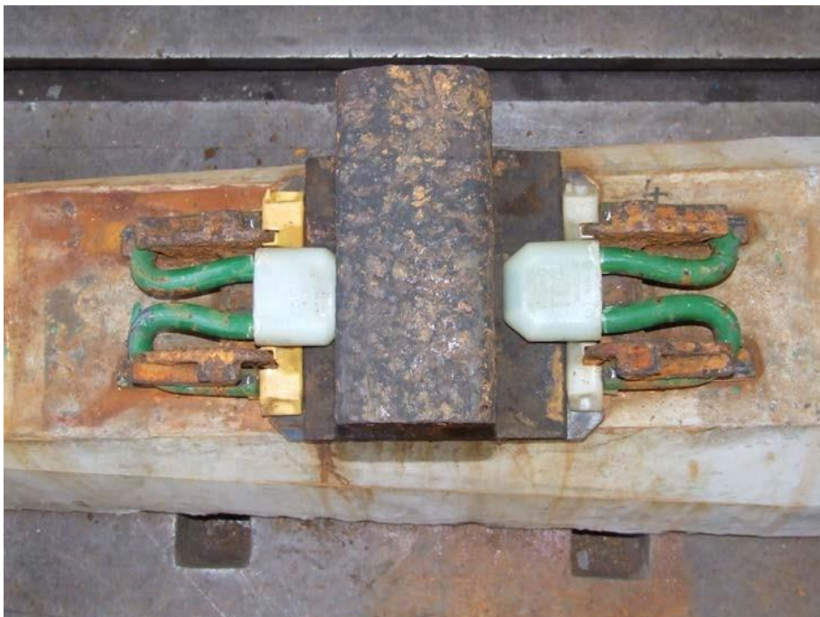
B.6 paveikslas: Sąranka po korozijos bandymo
